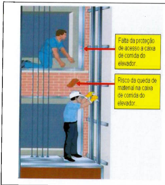
Figura 1: Queda de materiais devido a falta de proteção no pavimento
