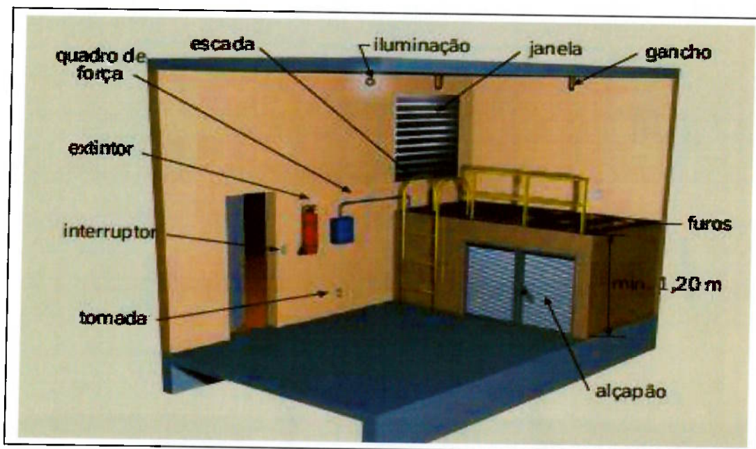
Figura 18: Casa de máquinas com dois níveis
